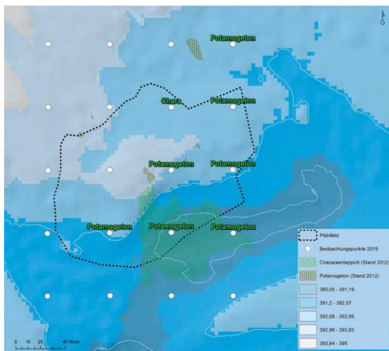
Abb. 5: Das Erosionsmarkernetz in der Fundstelle am Frauenpfahl mit Beobachtungen zur Makrophytenbedeckung. Das bathymetrische Modell beruht auf den Ergebnissen des »Tiefenschärfe«-Projektes der LUBW 2015; eingetragen sind Isohypsen der Vermessungen von 2001 und 2015.
