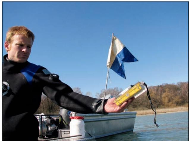
Abb. 2: Vermessung in der Flachwasserzone – Arbeit mit Hand-GPS.
